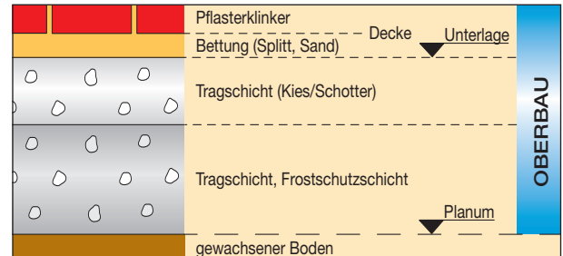
Aufbaubeispiel einer Befestigung mit Pflasterklinker
